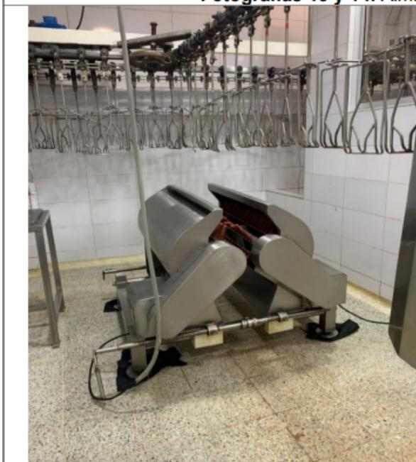
**Fotografía 15.** Máquina peladora de patas.
